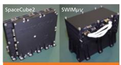
SWIM。左はJAXA-HIREC開発のMIPS-CPUを搭載した制御&データ処理モジュールSpaceCube2。右は宇宙実証試験モジュールSWIM  $\mu\nu$ 。SDS-1では超小型重力波センサーが搭載されている。
