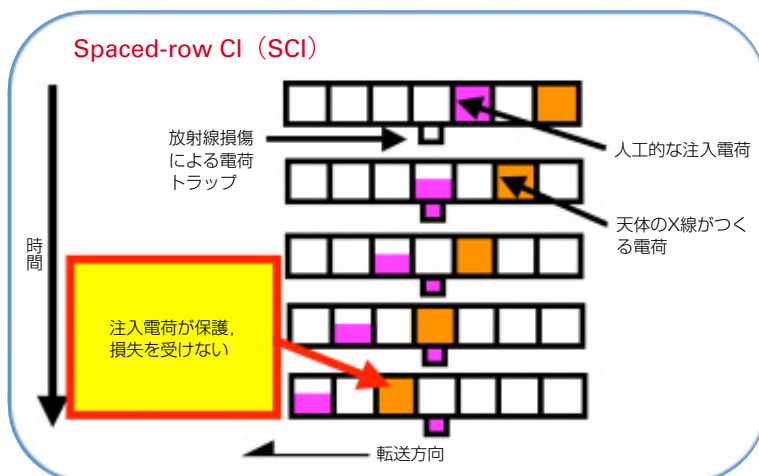
図34 電荷注入の仕組み 四角がCCDのピクセルを表す。
