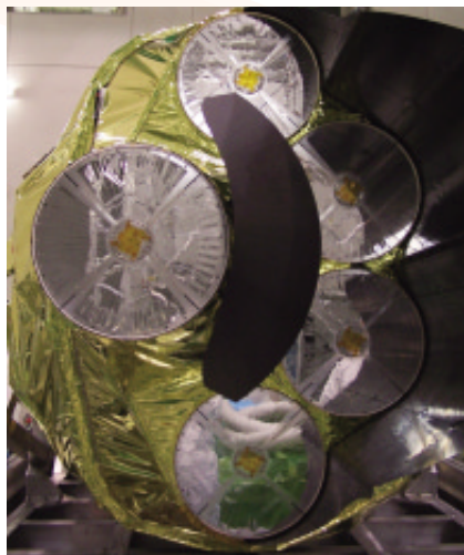
図39 「すざく」X線望遠鏡(XRT)の入射側に取り付けられたサーマルシールド
