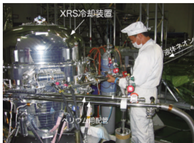
図36 上：XRS冷却装置の内部の様子。写真中央にセンサが入ったケースがあり、断熱消磁冷凍機と液体ヘリウム容器はその下にある(写真では見えない)。その周囲にあるビニールシートでカバーされているところが固体ネオン容器。下：液体ネオン転送の様子。写真左がXRS冷却装置で、右後方に見えるパイプがネオン転送管。手前は冷却用のヘリウム配管。
