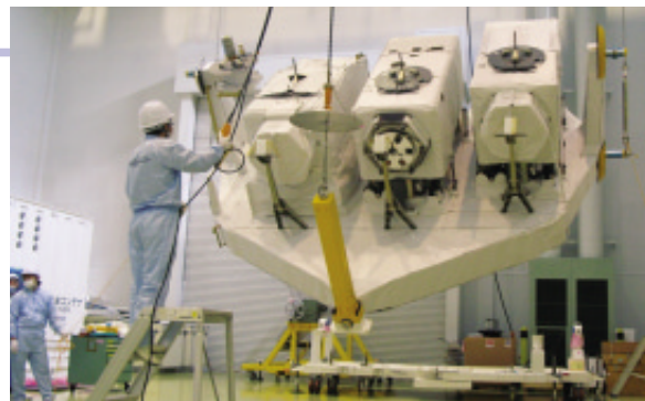
スペースシャトル搭載用の「きぼう」船外バレットに搭載された全天X線監視装置(MAXI:右)。左は同乗する衛星間通信装置、中央は宇宙環境計測装置。
