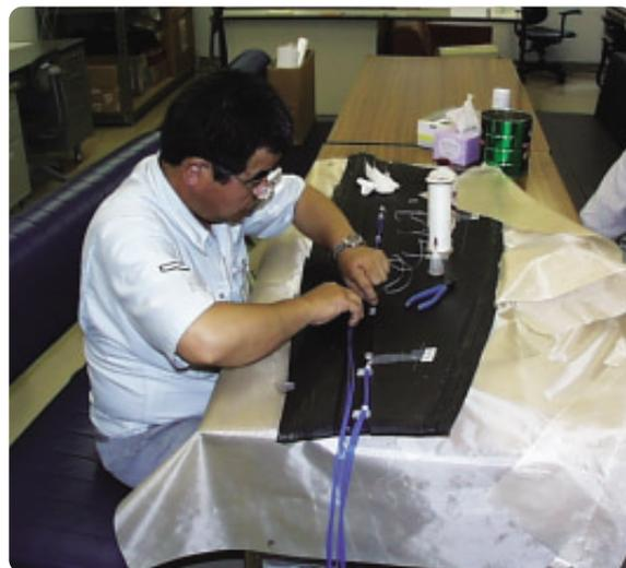
M-Vロケット1段モータ頭部耐熱ゴム温度センサ取付け作業
