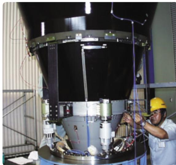
M-Vロケット3段モータ伸張ノズル温度センサ取付け作業
