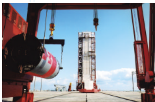
整備塔へ運搬されるロケット
