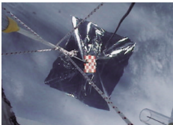
図1 差し渡し20mの正方形のソーラーセイル膜展開の様子
