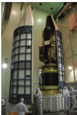
SOLAR-Bと第3段ロケットを被うノーズフェアリングの組み付け作業（9月9日）
