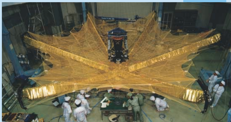
地上での最終アンテナ展開試験風景(各部分の動きを注意深く目視しながら行われました)
