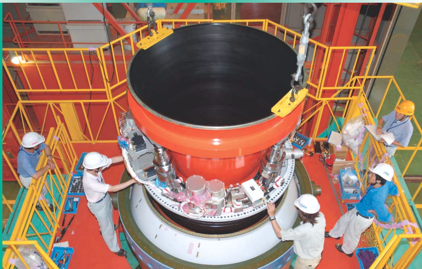
M-Vロケット7号機第1段ロケットのノズル結合作業（撮影：前山勝則）
