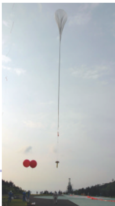
写真1 放球時の大気球と落下実験機体
