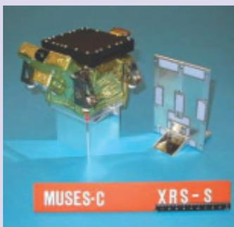
XRSセンサー部 (写真左)。写真の下方が小惑星方向で、鏡面のフード兼放射熱面の内側奥にCCDがある。左端部が標準試料 (写真右) 用の観測センサ開口部。
