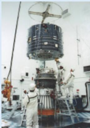
ジオテイル衛星のPAM-Dへの組付け作業風景
