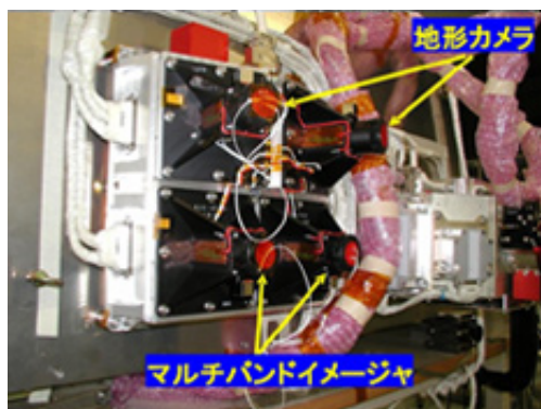
図1 SELENEに搭載される地形カメラとマルチバンドイメージャ。高解像度撮像で月の地形、地質のデータを収集する。
