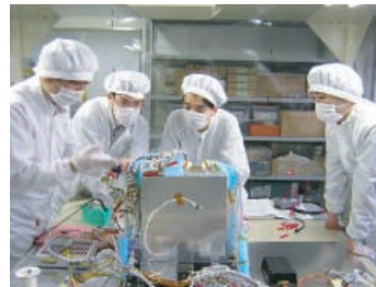
若手職員と学生によるINDEX衛星の実機噛み合わせ試験
