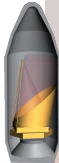
コロナグラフを応用したJTPFの可視光望遠鏡案。口径約3.5mの軸外し単一主鏡をH-IIAロケットのフェアリングに収めたもの。
