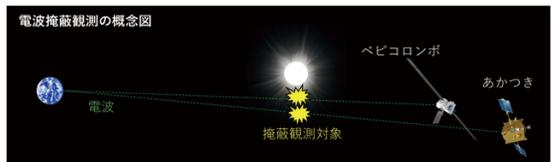
「ベピコロンボ」「あかつき」による電波掩蔽観測および「ひので」による太陽観測の概略図
