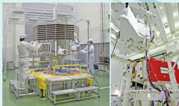
左：熱真空試験の準備作業中(ISASにて、2014年10月)。右：全機結合のためにクレーンで探査機を吊り上げている様子(ESTECにて、2017年5月)
