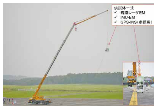
着陸レーダフィールド試験風景（2019/10大樹航空宇宙実験場にて）。
