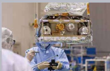
写真：(左) Resolveの試験の様子。(右) Xtendをつり上げて検査している様子。
