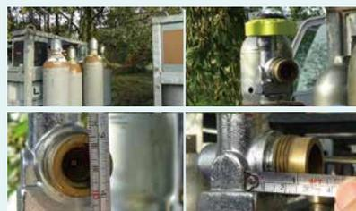
屋外一時保管中の気密試験用ボンベ(上段)と口金測定(下段)@ESTEC。
