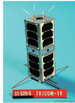
約10x10x30cm、3.2kg 超小型衛星 TRICOM-1R (「たすき」)。
