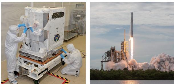
図4 中性子星を主目的にしたX線望遠鏡NICER(左)は、国際宇宙ステーションに搭載すべくSpaceX社のFalcon 9ロケットで打ち上げられた(右)。©NASA
