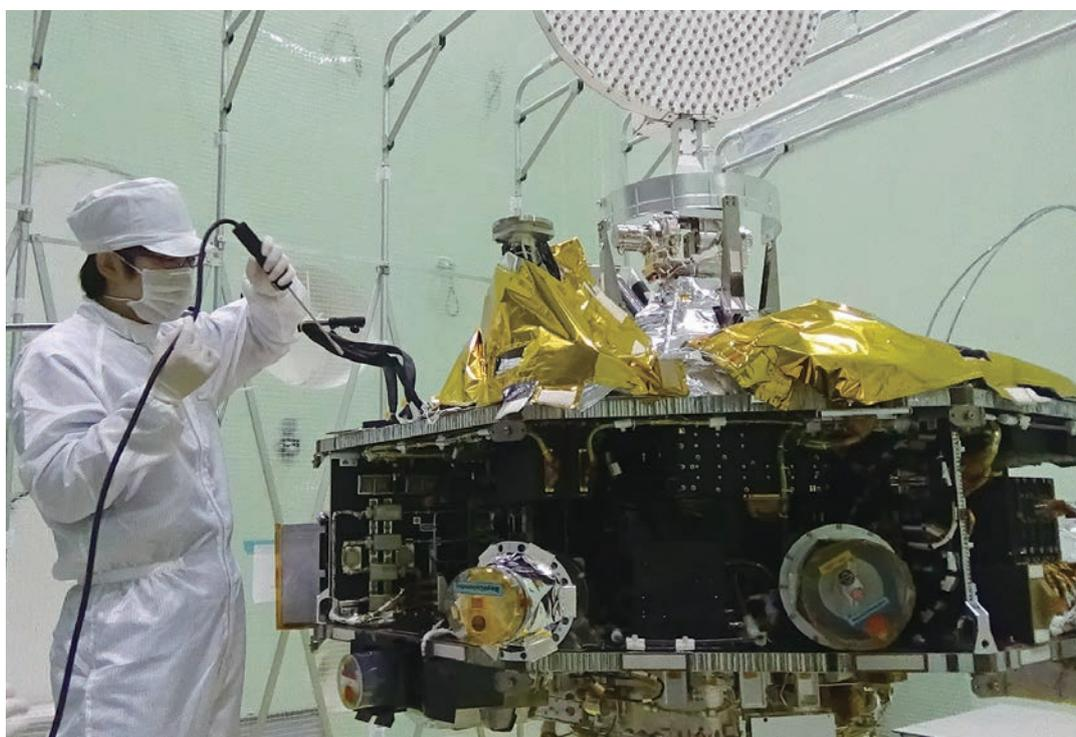
12月17～19日にかけて欧州宇宙技術センター(ESTEC)で行われた水星磁気圏探査機(MMO)の推進系リーク試験の様子
