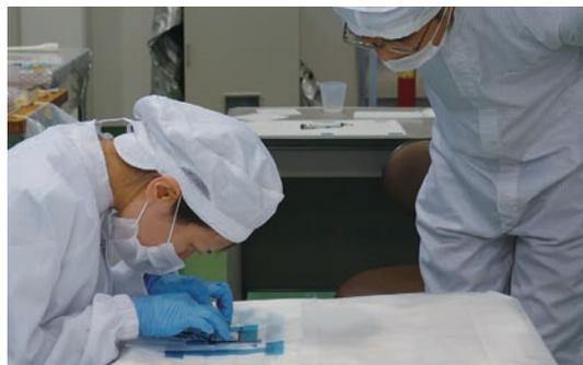
衛星パネル(フライトモデル)へのOSRの施工
