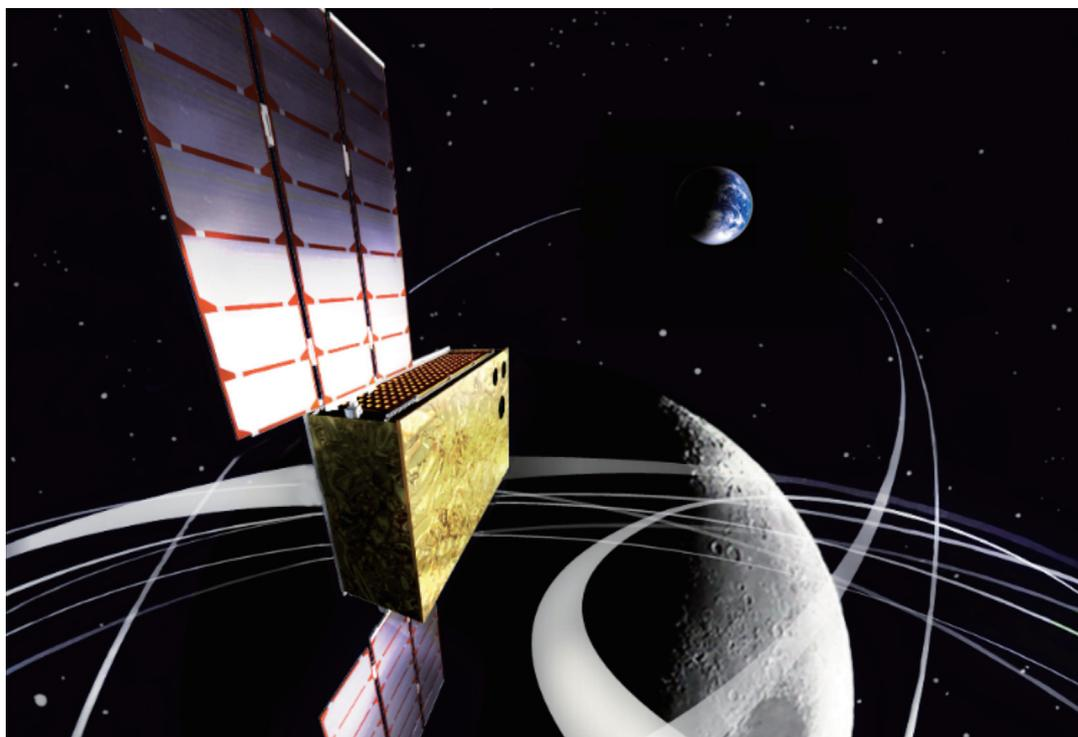
EQUULEUSは、地球一月系ラグランジュ点(地球と月の重力が釣り合う平衡点)のうちのL2点へ飛行し、L2点を周回する軌道から月の裏側と地球を観測します。超小型衛星の中でも、10×10×10cmを1U(Unit)と定義し、1U、2U、3U…のように規格化されたサイズで開発される衛星をCubeSatと呼びます。標準化された搭載機器開発が容易であることもあり、CubeSatの打上げ数が近年特に飛躍的に伸びてきていて、ついに深宇宙探査の世界にも乗り出そうとしています。
