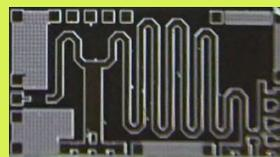
製作中のナノRFデバイス(整流回路)
