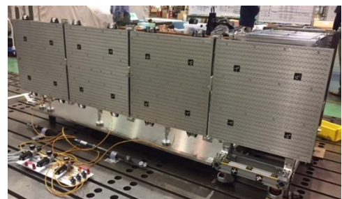
アンテナパネル展開完了状態(片翼)
