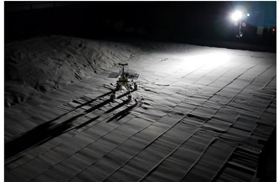
宇宙探査フィールドでの探査ローバの実験の様子
