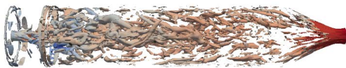
Fig. 4 ハイブリッドロケットエンジン内部のシミュレーション結果
