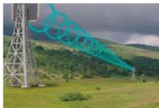
初期段階の技術実証実験。地上設置された送電・受電装置の間で、マイクロ波によりエネルギーを伝送。
