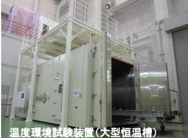
温度環境試験装置(大型恒温槽)
