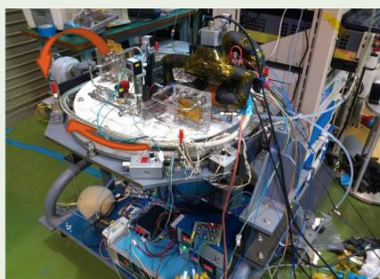
回転台車上に構築した小型試作システム(FC側のみ完成)
