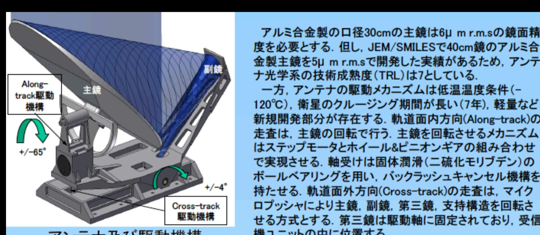
アルミ合金製の直徑30cmの主鏡は6μm r.m.sの鏡面精度を必要とする。但し、JEM/SMILESで40cm鏡のアルミ合金製主鏡を5μm r.m.sで開発した実績があるため、アンテナ光学系の技術成熟度(TRL)は7としている。
