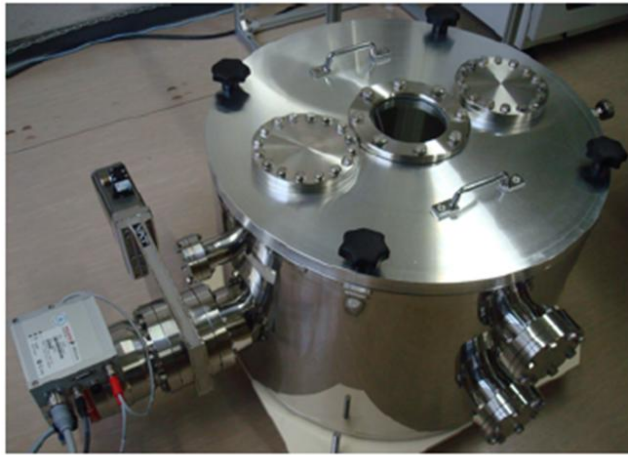
図3: 磁気流体シール用ポート付きチャンバ
