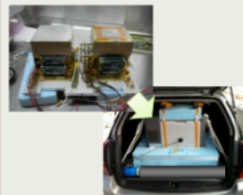
(写真) 実地試験で使用した装置。「超広角コンプトンカメラ」モジュールを2つ並べて感度を向上させたものを、冷却ボックスに入れて、車載した状態で測定をおこなった。
