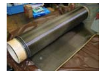
東邦テナックス製 IM-600 6K デザイズクロス 目付量:195g/m²
