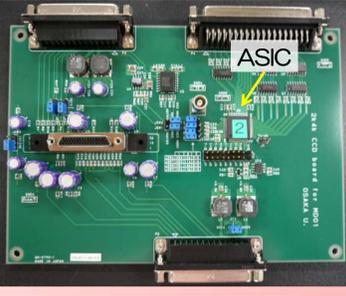
SD-CCD素子で取得した観測データ(微弱アナログ信号)は、カメラ内部のビデオボードでデジタル化・復号化(decimation filter)され、Mission I/O ボードに送られる。
