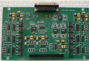
SD-CCDを駆動するアナログ信号を生成する。互いに独立だが等価な回路を持つ3枚の基板で構成され、各々が1素子の駆動を担当する。また温度制御用回路も実装され、ヒーターによりSD-CCD素子の温度をPID制御する。ドライバボード自身及びビデオボードの各種House Keepingデータはドライバボード内部でデジタル化して後段のMIOボードにより収集される。
