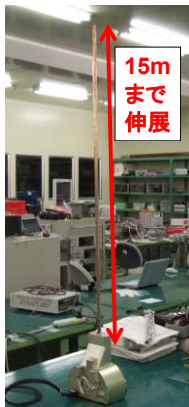
BeCu Interlocked Bistem Antenna (Kaguya) 2kg/unit → 重すぎ
