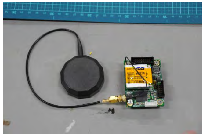
図 4: イリジウム SBD モジュール (9603 型) を用いた通信装置。
