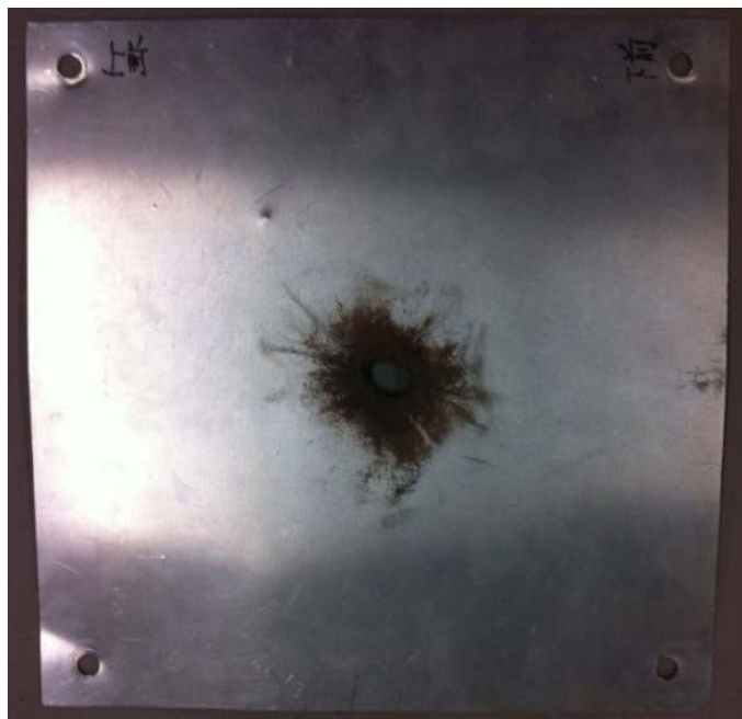
メカノクロミズム金属錯体 無しの衝突試験結果 (高温で焦げるのみ)
