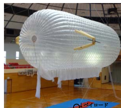
図 8 Powered balloon モデルの試作
