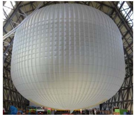
図 4 加圧試験(tawara4S3), 圧力差 500Pa
