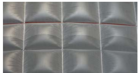
図 4 加圧試験(tawara4S3), 圧力差 500Pa
