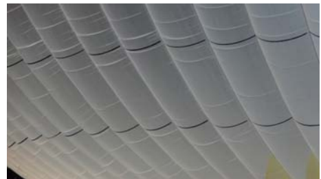
図 5 キャップ端部と下部の拡大図(tawara4S3), 圧力差 500Pa
