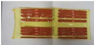
図3 熱融着層付ポリイミドフレキシブル集電路
