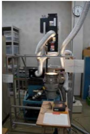
図5 UV 照射試装置
