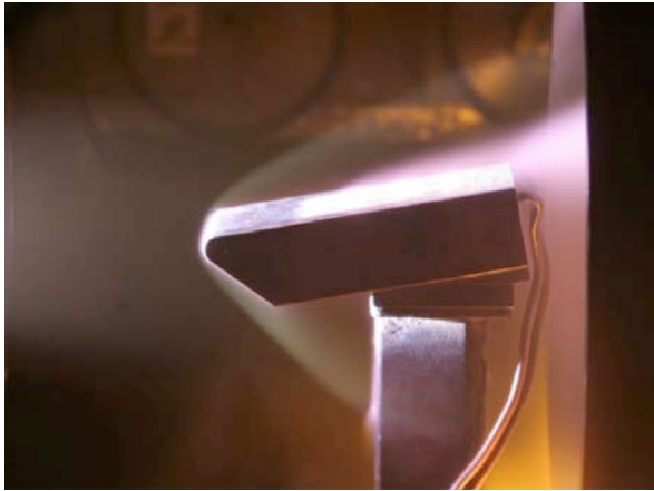
図 4 AWT エアロゲル加熱試験.
