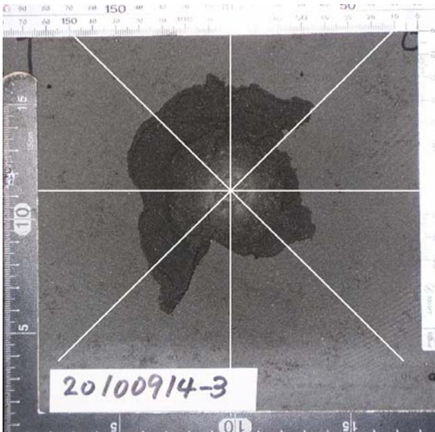
図2. クレーター直径測定方法
