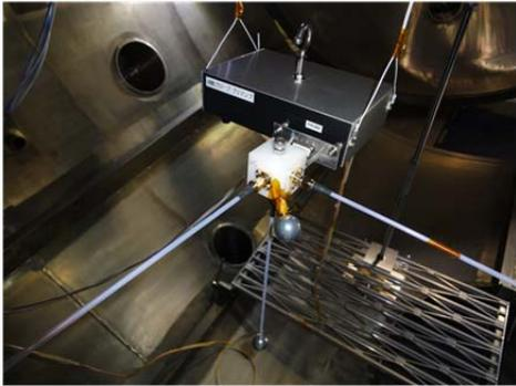
図 5: プラズマ波動観測センサー.
