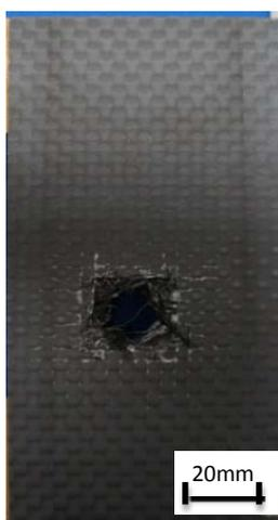
Fig.6 衝突角度 45°の貫通孔の様子
