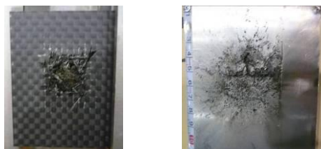
(a) 第一パネル (CFRP Cross ply, 3mm) (b)第二パネル: (6061Al, 2 mm) Fig.3 衝突角度60°の場合のパネル表面
