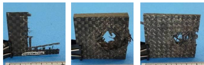
a)最前部 (b)中間部 (c)最後部 Fig.4 衝突角度90°の場合のパネルの損傷。 (厚さ20 mmの平織り積層 CFRP)
