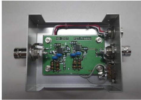
図3. 製作している電流電圧変換アンプ。真空対応になっている。
