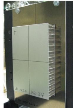
図1 模擬構体パネルと模擬筐体
