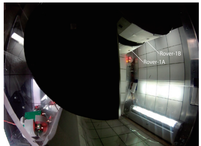
図2 ローバ分離メカニズムの無重力実験の様子
