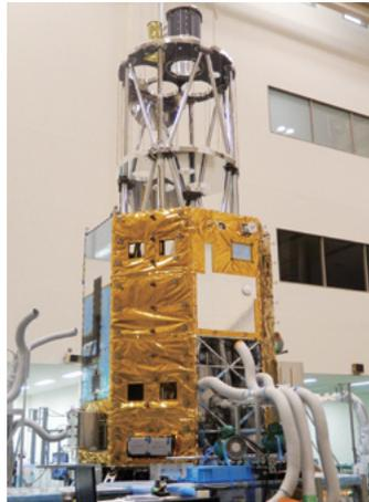
FNC-D試験の様子。高発熱機器を冷やすために多くの送風機を使っている。
