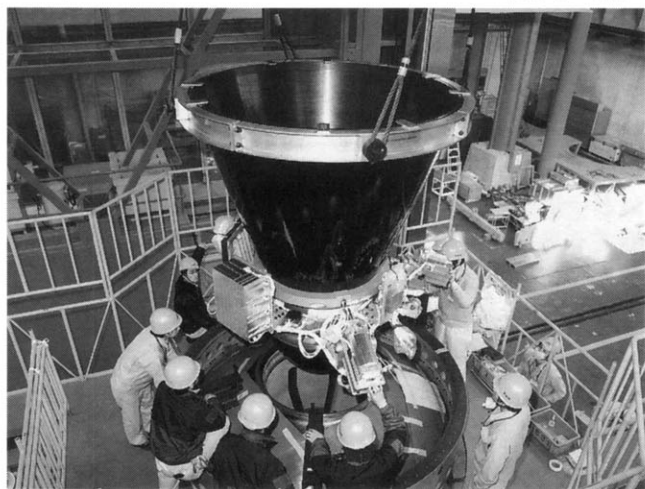
第2段モータ(M-25)とノズルの結合作業
