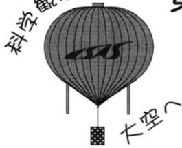
科学観測のための飛行体の一つにポリエチレン気球があります。500kg程度の観測器を軽々と持ち上げ5m/sec程度のゆっくりとした速度で大空に上昇する姿は、衛星を搭載したロケットとはまた違った力強さがあります。通常気球は葉の形をした厚さ20 $\mu\text{m}$ (0.02mm)のポリエチレンフィルムを熱接着により貼り合わせて作りますが薄いフィルムには大変気を遣う作業になります。気球の放球作業でも同じことが言えます。10年程前から10kg程度の軽い観測器を、40kmを越え50km以上の高度に飛行できる科学観測用気球の開発(下図)を行ってきました。図中BTはフィルム厚が5.8 $\mu\text{m}$ 、BUは3.4 $\mu\text{m}$ で製作した気球で各々薄膜型高高度気球、超薄型高高度気球と呼んでいます。
