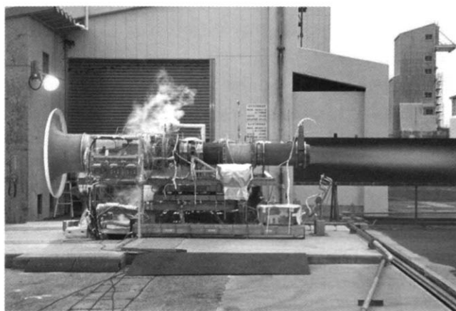
図3：ATREX エンジン地上燃焼試験
