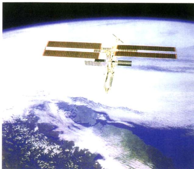
写真2 4枚のPIソーラバドルを拡げた宇宙ステーションISS (Space Flight, vol.43, No5. (2001)より転載)
