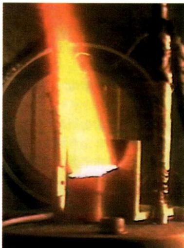
写真3 減圧窒素雰囲気下でのGAP/APの燃焼状況
