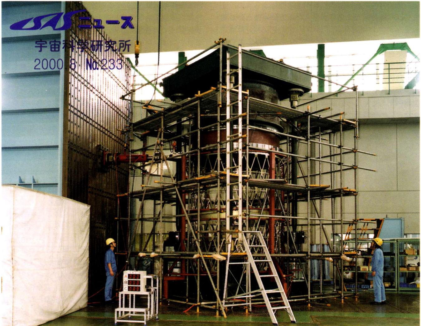
▲M-V型ロケット新1/2段接手の静荷重試験（本文記事参照）（撮影：前山勝則）
