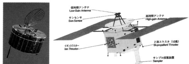
ハレーすい星探査機 「さきがけ」 円柱スピン型(スピン 軸は黄道面に垂直)
